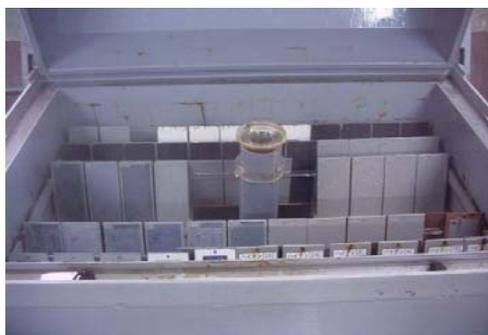
規程の試験後、塗装面からの錆・塗膜の膨れ及びはがれは発生しませんでした。
